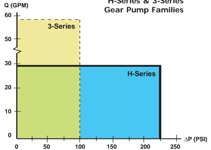
**3-Series: Standard Duty Gear Pump**
